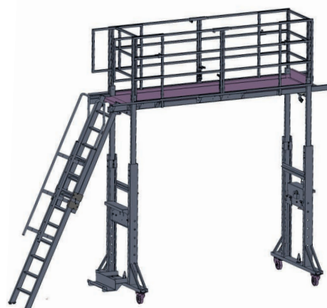
Plateforme en position haute, échelle dépliée et garde-corps fermés.
