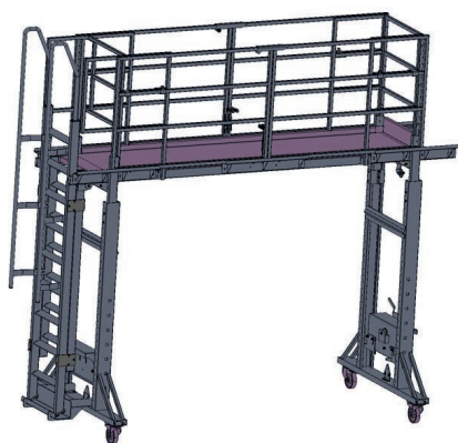
Plateforme en position basse, échelle repliée et garde-corps fermés.
